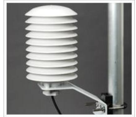
気温計測用の自然通風シェルター付き温度センサーです。内部には高精度なクラス A の 3 線式 Pt100 白金測温抵抗体を搭載しており、精密な気温計測が可能です。シェルター部分は反射効率に優れ、熱伝導率の低い耐候性プラスチック円盤で構成されており、外気温を的確に捉える自然通風設計となっています。
