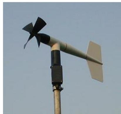
本センサーは、弱風から強風までワイドレンジに測定可能な風向風速計です。飛行機型風向風速計は、一般的な風向風速計で、高精度・広範囲に測定でき、耐久性にも優れています。他の飛行機型タイプと比較して小型・軽量設計ですので、設置も容易です。このタイプは、電流出力ですので、ケーブルを長距離に延ばし、汎用データロガーや計測機器に入力することが可能です。
