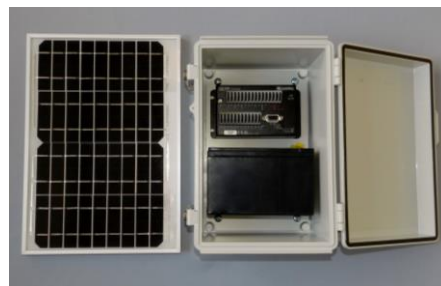
写真は太陽電池電源仕様
