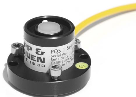
本センサーは、高精度・高信頼性の光量子計です。太陽光の全波長のうち植物の光合成に有効な400~700nmの波長に対応します。防水アルマイト、アクリル拡散板付きで、全天候下での耐環境性・信頼性も兼ね備えておりコンパクト構造ですので、移動観測にも最適です。
