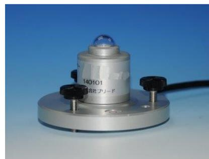
本センサーは、太陽から放射している紫外線（UV-A 波と UV-B 波を合計した感度）を簡易的に測定できる小型の紫外線計です。受光部にはフォトダイオードを使用しています。また、全天候下での耐環境性も兼ね備えておりコンパクト構造ですので、移動観測にも最適です。
