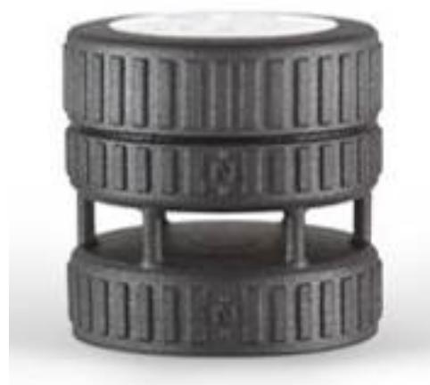
本製品は、ドローン（無人航空機、UAV）搭載用に軽量（約 100 g）に設計された 2 次元超音波風向風速計です。センサー内にはコンパスが内蔵されています。コンパクトサイズのため、物理的衝撃に強い形状になっています。また、電氣的な干渉に強く、高度 4000m まで、 $-20^{\circ}\text{C}\sim 70^{\circ}\text{C}$  の温度環境で動作します。また、低消費電力駆動で、風速 75m/s まで計測が可能です。
