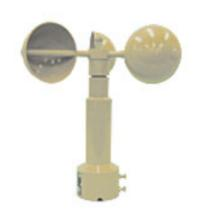
~20mA の風速値に対応した電流信号を変換出力します。直線化されたアナログ信号ですので、データロガーなどの受信側機器とダイレクトに接続できます。
