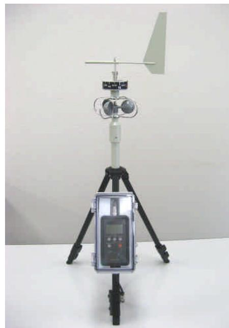
本機は、小型・軽量なポータブルタイプのデジタルハンド風向風速計です。発信器は防護カバー、指示器は防水ケースに格納され、スポーツ競技・工場・ビルでの安全確認等、さまざまなニーズに対応できるように使いやすさと機能の両立を図っています。指示器は、瞬間風速・平均風速・最大瞬間風速・風程の4種類が測定可能で、平均風速・最大瞬間風速リセット時間は1～600秒で任意に設定できます。本体は付属のアルミケースに収納され、持ち運び時の破損を防止し、付属の三脚で簡単に設置できます。また、瞬間風速レベルメーターで風の動きを視覚的に確認できます。
