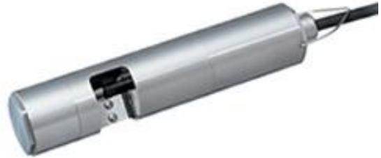
本センサーは、連続的に濁りをモニタリング可能な濁度センサーです。検出窓の洗浄は、ワイパーふき取り式のため、1 ヶ月に1度程度、窓面を確認するだけの簡易メンテで計測ができます。また、信号線が電流出力のため、外部ノイズ等の影響が少なく、ケーブルを長距離に延ばせます。
