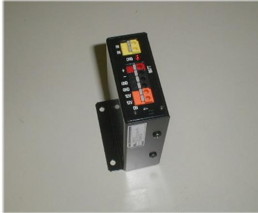
本体は、AC100V または太陽電池パネルなどから外部バッテリーの過充電コントロールを行い、センサーや計測機器などへ安定された DC12V を供給します。出力過電流保護や短絡保護回路も内蔵されていますので、安心して使用できます。
