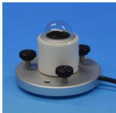
本センサーは、ローコスト・高精度な小型日射計です。受光部は、サーモパイルを使用しているため高感度・高精度で、応答性も早く、波長範囲（300～2800nm）も広い日射計です。
