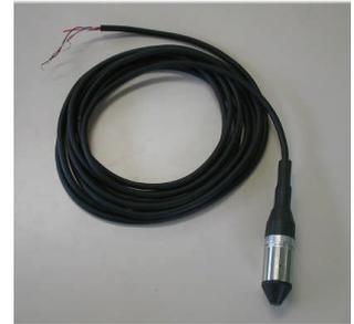
本センサーは、ローコストタイプの水位センサーです。筐体はステンレス製で、地下タンク・工場タンク等のレベル測定の使用に最適です。水位レベルのラインナップは 2m、5m、10m のみで、出力信号は 1~2VDC です。
