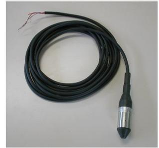
本センサーは、ローコストタイプの高精度な圧力式水位センサーです。筐体はステンレス製で、地下タンク・工場タンク等のレベル測定の使用に最適です。水位レベルのラインナップは 2m、5m、10m のみで、出力信号は 1~5V または 4~20mADC を選択できます。
