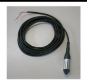
本センサーは、オールチタン製の高精度の投げ込み式水位センサーです。筐体に耐食性が抜群のチタンを使用していますので、海水の潮位観測にも対応できます。大気開放パイプを内蔵した専用ケーブルを使用していますので、大気圧変動に瞬時に対応できます。電圧出力(1~5VDC)と長距離伝送可能な電流出力(4~20mA)が選択できます。
