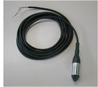
本センサーは、二重ダイアフラム構造の高精度な圧力式水位センサーです。超低消費駆動ですので、電源のない場所での長期観測に最適です。筐体はステンレス製のため耐食性に優れており、ケーブルは大気圧変動に瞬時に対応できる大気開放パイプを内蔵した専用のケーブルを使用しています。2m~50m 計の幅広いラインナップですので、河川、水路、ダム、井戸、地下水位等のさまざまな用途でご使用いただくことができます。
