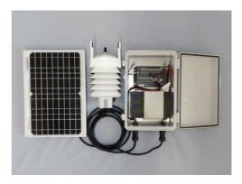
本製品は、複合気象センサーWXT536 と計測器(データロガー)のセットです。計測器とバッテリーは防水ケースに収納されていますので、センサーと防水ケース、太陽電池パネルを現場に設置するだけで計測データが内部メモリに記録されます。他のセンサーの接続も可能ですので、詳細はお問い合わせください。
