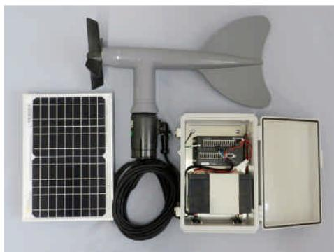
本製品は、飛行機型風向風速計 FTJ500 と計測器 (データロガー) のセットです。計測器とバッテリーは防水ケースに収納されていますので、センサーと防水ケース、太陽電池パネルを現場に設置するだけで計測データが内部メモリに記録されます。
