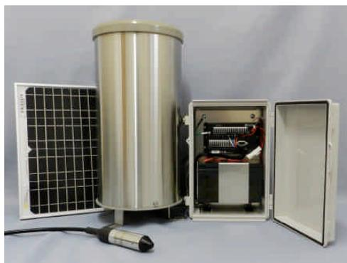
本製品は、転倒ます型雨量計 34T-BP、水位センサーHM500 と計測器(データロガー)のセットです。計測器とバッテリーは防水ケースに収納されていますので、センサーと防水ケース、太陽電池パネルを現場に設置するだけで計測データが内部メモリに記録されます。
