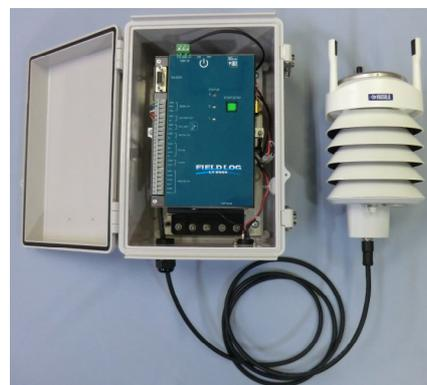
本製品は、複合気象センサーWXT536と計測器（データロガーFieldLog-LT2000）のセットです。計測器と電源は太陽電池パネル付きの防水ケースに収納されていますので、センサーと防水ケースを現場に設置するだけで計測データがSDカードに記録されます。ロガーの設定は付属の専用ソフトウェアでパソコンから行います。
