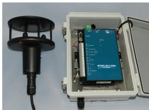
本製品は超音波風向風速計 WindSonic と計測器（データロガー FieldLog-LT2000）のセットです。計測器と電源は太陽電池パネル付きの防水ケースに収納されていますので、センサーと防水ケースを現場に設置するだけで、計測データが SD カードに記録されます。ロガーの設定は付属の専用ソフトウェアでパソコンから行います。**その他のセンサーの追加接続についてはお問い合わせ下さい。**
