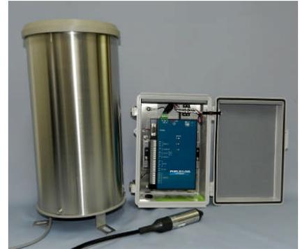
本製品は水位計・雨量計及び計測器(データロガー FieldLog-LT2000)のセットです。記録計と電源は太陽電池パネル付きの防水ケースに収納されていますので、センサーと防水ケースを現場に設置するだけで、計測データが SD カードに記録されます。**その他センサーの追加接続**についてはお問い合わせ下さい。
