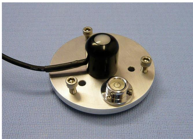
本センサーは、ローコスト・高精度な小型日射計です。全天候下での耐環境性・信頼性も兼ね備えておりコンパクト構造ですので、移動観測にも最適です。
